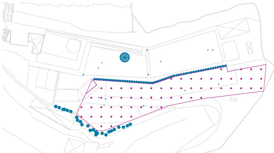
Superficie de cálculo 5: Intensidad luminica perpendicular (Trama)
